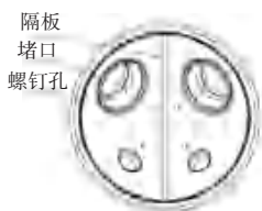
图1 核电蒸汽发生器水室内部堵口
