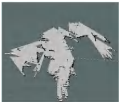
图 7 深度相机仿激光数据建图
