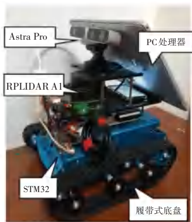
图 5 履带式室内移动机器人
