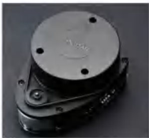
图 1 思岚 RPLIDAR A1 激光雷达
