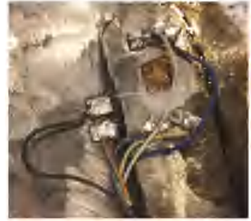
图 1 盲孔法测量应变图
