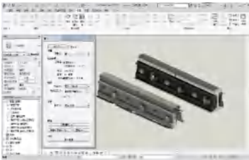
图 6 根据三维扫描图建立的构件模型
