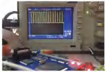
图 4 SPWM 波形 Fig. 4 SPWM waveform
