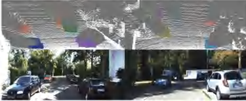
图 3 基于 KITTI 3D BBox 注释生成的实例分割
