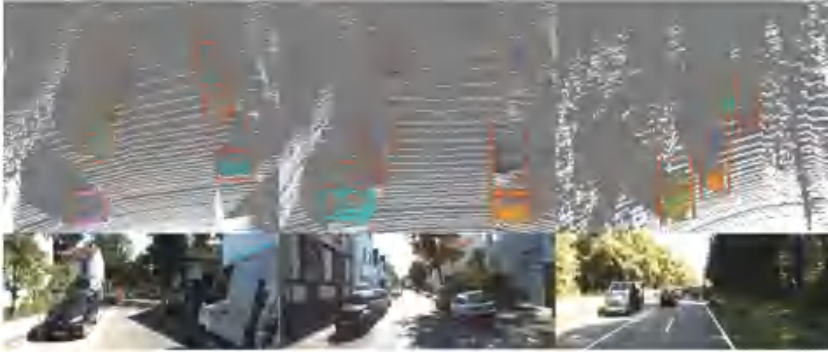
图5 在KITTI基准上联合实例分割和3D对象检测的3个示例
