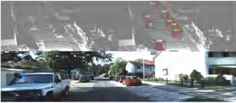
图1 来自LiDAR点云的3D实例分割和目标检测示例
